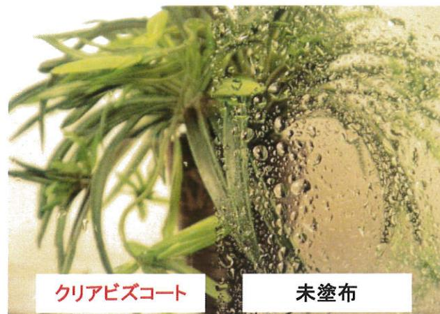
未塗布面では水滴による乱反射が発生、クリアビズコート面では薄い水膜となるため、乱反射が抑えられ、視界が確保されます。
